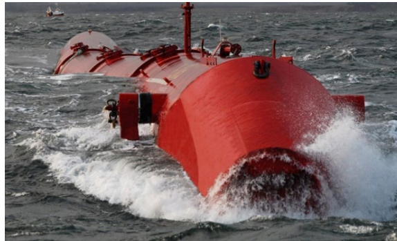
Gambar 1. Pelampung Baja Pada Pembangkit Listrik Tenaga Gelombang Laut (Builder, 2022)
