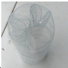
Gambar 8 A. Perakitan bekas botol minuman, B. Penyusunan di dalam Bak Filter
