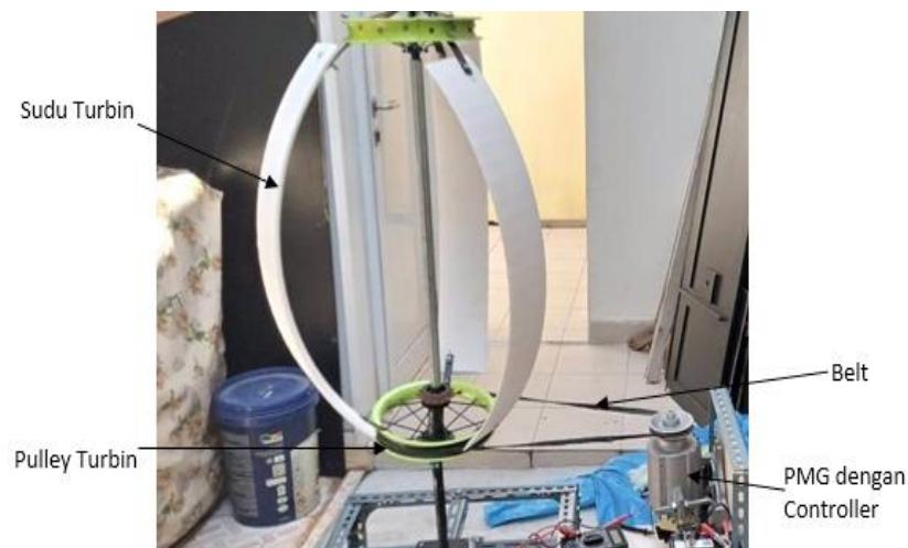
Gambar 4 Turbin Angin Darrieus yang sudah dibuat
