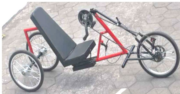
Gambar 1.1. Sepeda Tangan Untuk Penyandang Cacat ( Handcycle )
