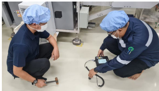
(c). Pengujian Getaran dengan alat VIBXPERT II
