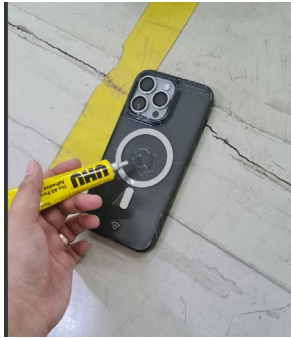
(a). Smartphone diletakan dan direkatkan pada lantai agar smartphone mendeteksi getaran lantai
