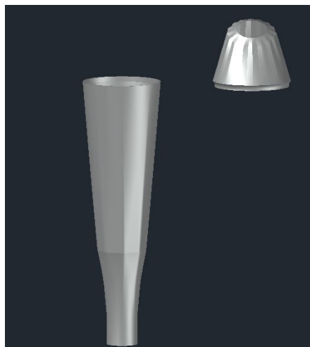
Gambar 3 Prototipe End Cap Knalpot Terpisah
