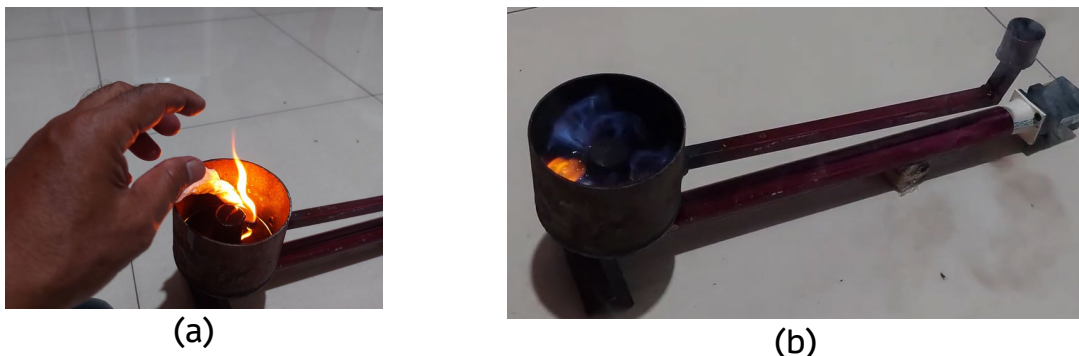
Gambar 7. Burner dipanaskan (a), Udara masuk untuk menyempurnakan pembakaran. Api berwarna biru (b)
