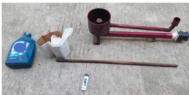
Gambar 2. Burner Berbahan Bakar Oli dengan Kelengkapannya: Burner berikut Blower; Tongkat Kayu; Korek Api; Oli Bekas; Kertas.
